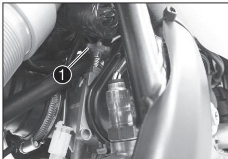
Настройка холостого хода на корпусе дроссельного клапана оказывает большое влияние на режим пуска мотоцикла, стабильность холостых оборотов и характер реагирования на открытие дроссельной заслонки.
