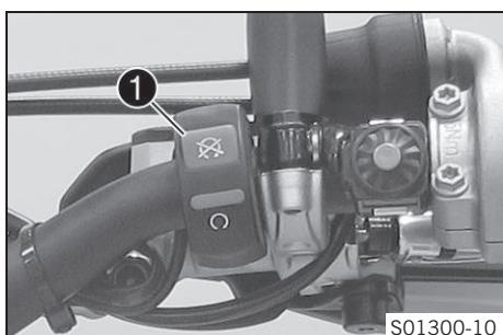
Аварийный выключатель зажигания ① расположен на правой рукоятке руля.
