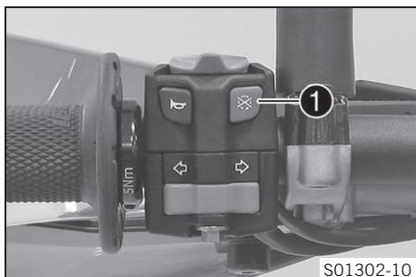
Электронный выключатель зажигания **1** расположен на левой рукоятке руля.
