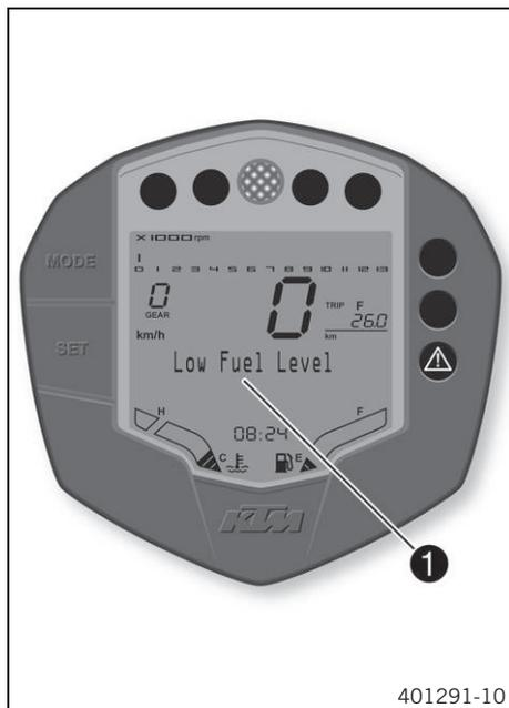
На информационном дисплее **1** отображаются различные предупреждающие сообщения. При включении общего предупреждающего индикатора
