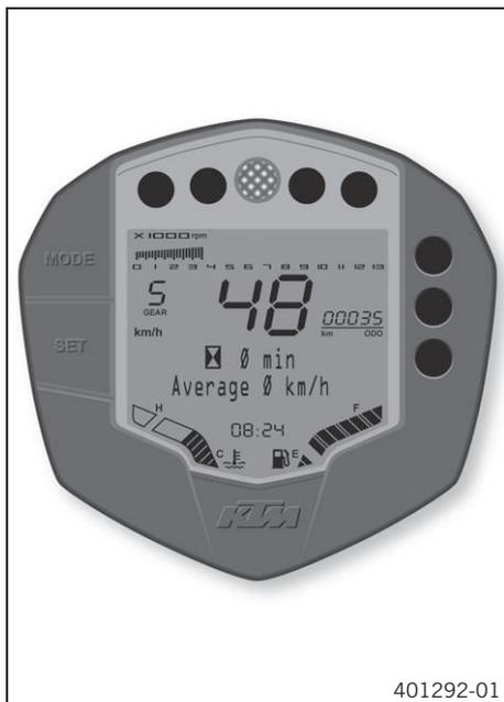
Индикатор температуры состоит из 13 сегментов. Большее количество активных сегментов соответствует более высокой температуре. При активации всех сегментов индикатора на информационном дисплее отображается сообщение **High Coolant Temperature** (Высокая температура охлаждающей жидкости).
