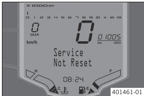
Сообщение **Service Not Reset** (Сервис не переустановлен) отображается на информационном дисплее в течение 10 секунд, если зажигание включено и превышен интервал дистанции пробега между назначениями сервиса, или же дисплей сервисного интервала не был переустановлен во время назначения сервиса.
