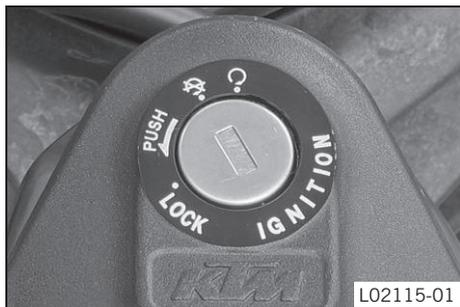
Замок зажигания/рулевой колонки расположен перед верхней траверсой руля мотоцикла.
