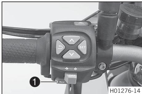
Кнопка звукового сигнала **1** находится слева на комбинированном переключателе.
