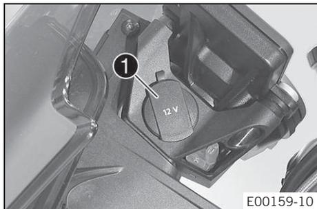
Гнездовой разъем ❶ для дополнительного электрического оборудования установлен на левой стороне опоры щитка приборов.
