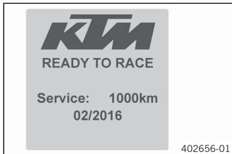
После включения зажигания кратковременно появляется дисплей сервисных интервалов. Сервисные интервалы зависят от пройденного расстояния или истекшего периода времени. При этом применяется первое из достигнутых предельных значений.
