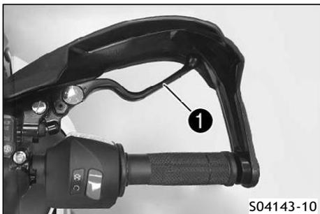
Рычаг переднего тормоза **1** расположен на правой рукоятке руля. Передний тормоз задействуется с помощью рукоятки переднего тормоза.
