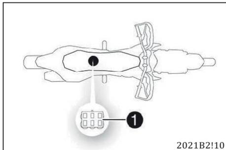
Разъем диагностики **1** расположен под блоком управления электроникой двигателя.
