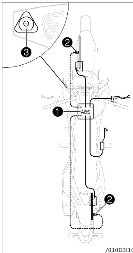
Антиблокировочное тормозное устройство **1**, состоящее из гидравлического блока, блока управления ABS и возвратного насоса, установлено под топливным баком. На переднем и заднем колесах размещены датчики частоты вращения колеса **2**.
