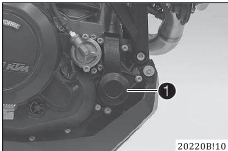
Водяной насос **1** в двигателе обеспечивает циркуляцию охлаждающей жидкости.
