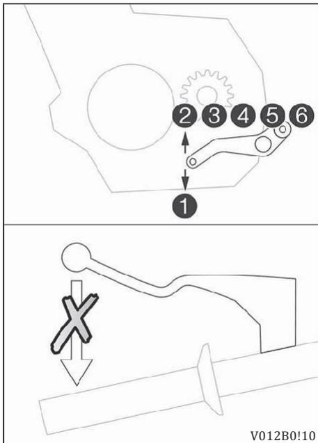
Если активирована система быстрого переключения передач Quickshifter + (опция), водитель может переключать передачу вверх под нагрузкой и вниз, не выжимая сцепление.
