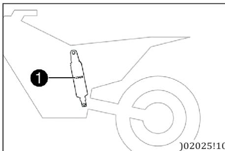
Номер амортизатора **1** на левой стороне амортизатора.
