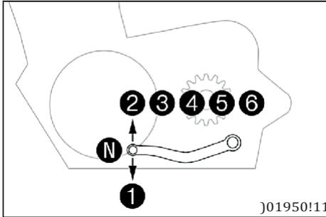
Схема расположения передач показана на иллюстрации.
