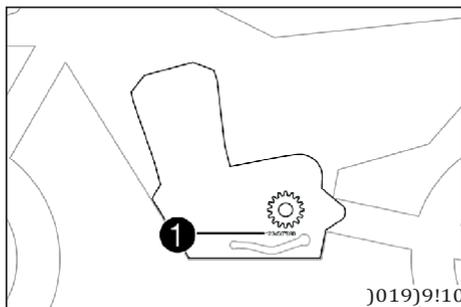
Номер двигателя **1** выбит на левой стороне силового агрегата, под ведущей звездочкой.
