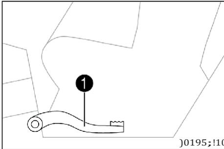
Рычаг ножного тормоза **1** находится перед правой подножкой. Задний тормоз задействуется с помощью рычага ножного тормоза.
