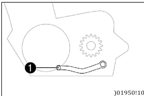
Рычаг переключения передач **1** расположен на левой стороне двигателя.
