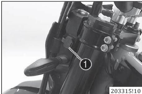
USB-разъем **1** для питания внешних устройств расположен на левой стороне защитной крышки передней фары.
