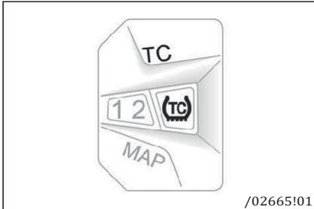
Антипробуксовочная система (**МТС**) понижает крутящий момент двигателя при потере сцепления заднего колеса с дорогой.
